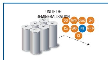
Pour une unité de déminéralisation, la mesure en ligne du sodium repose sur la gestion des résines échangeuses d'ions.
