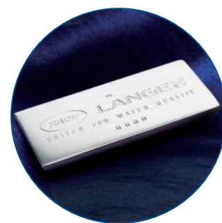
Fig. 5 : Quand les déchets sont esthétiques ! Lingot d'argent récupéré à partir de réactifs DCO traités par électrolyse.
