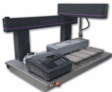
Fig. 6 : robot pour la détermination automatisée de la DCO
