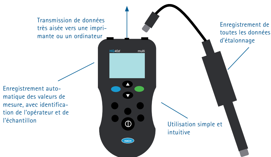
Fig. 1 : Schéma du HQD et de ses principales fonctionnalités.
